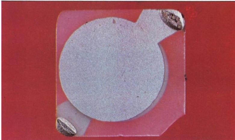
Lámina de cuarzo piezoeléctrico en forma cuadrada en la que se observa las metalizaciones de sus dos caras
